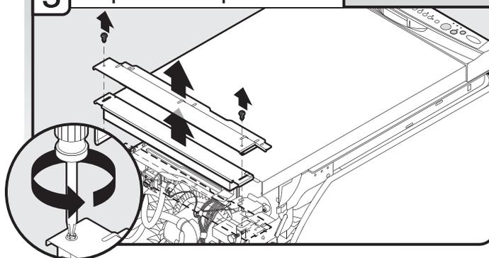
Utiliser un tourne-écrou hexagonal de 1/4" ou un tournevis Phillips; ôter les deux vis fixant le panneau de l'ouverture d'accès et le panneau de plinthe sur le lave-vaisselle. Ne pas enlever la fiche technique collée sur le panneau de l'ouverture d'accès.
